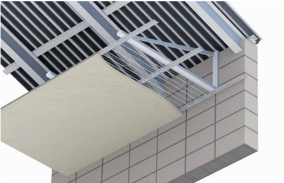
*Están formadas por una estructura autoportante, anclada a la medianería y con una longitud mínima de 1 metro, sobre la que se pueden aplicar morteros ignífugos.*
